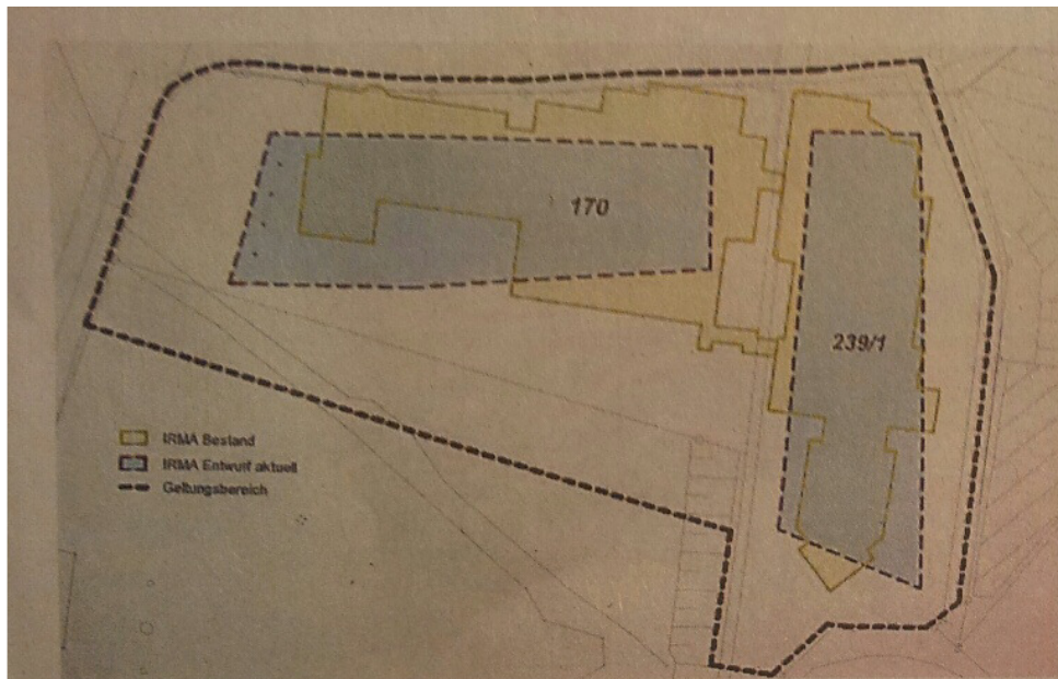
Gelb ist die Grundfläche des alten Irma-Gebäudes, blau der Entwurf für den Neubau von zwei Gebäuden. Plan: Rebholz
